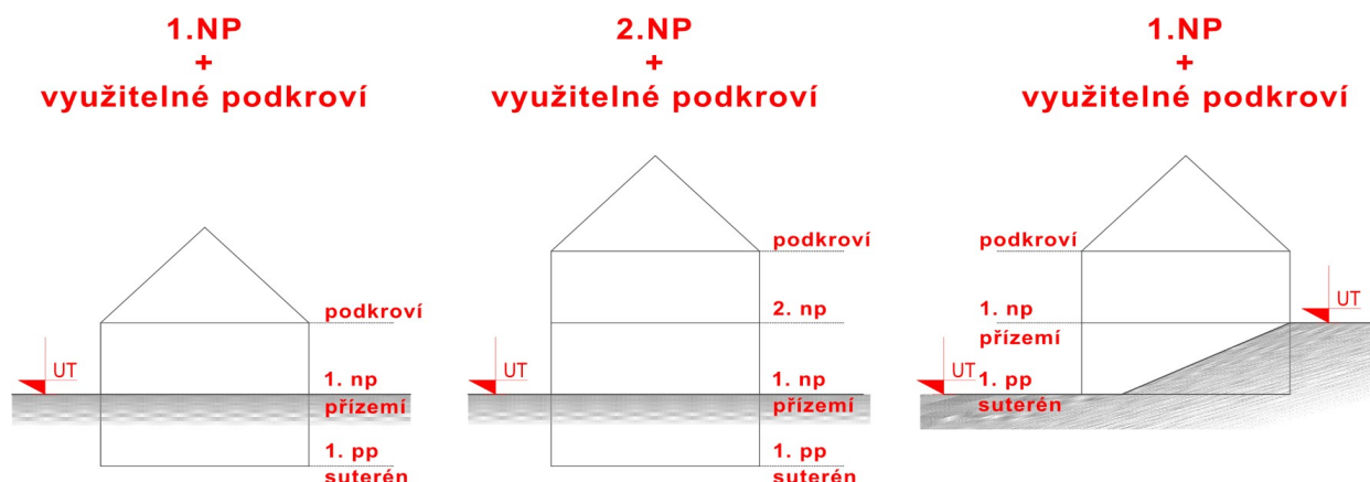
Obr. č. 3 - Schéma přípustné podlažnosti dle morfologie terénu
